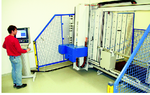
Das neue Bearbeitungszentrum für Fräsen, Bohren und Gewinde schneiden an Schaltschränken und Montageplatten.
