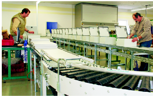
Die weitere Montage von Geräten und Komponenten erfolgt über moderne Rollbahnsysteme. Fotos: Becker
