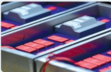
HV-Module mit Polyurethanverguss
