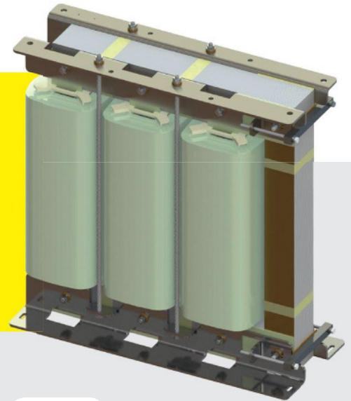
Die Dreiphasendrossel mit Common-Mode Unterdrückung dient als normale Filterdrossel. Der vierte Schenkel dient zusätzlich zur Gleichtaktunterdrückung.
