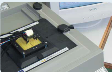
EDV-gestütztes Prüffeld für Induktivitäten IT-oriented test field for inductive components
