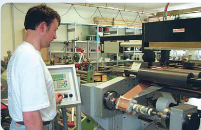
Bandwickeltechnik (Alu/Kupfer) bis 1 m Breite Foil winding technology (alu/copper) up to 1 m width
